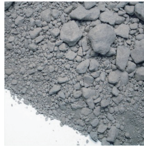
写真 2 鉄鋼スラグ路盤材と道路施工状況
